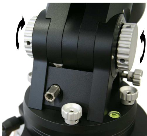
Fig. 4.13: Unlocking the altitude axis.
